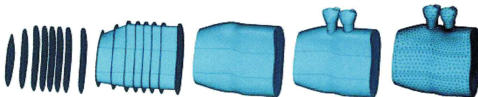
図 2. 個別有限要素モデルの構築手順。左から右へ、断面形態の製作、断面の連結と延長による海綿骨領域の製作、皮質骨領域の製作、小臼歯モデルと歯根膜の埋入、メッシュ分割による完成。
