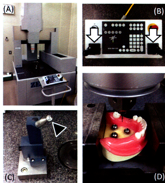
図 2. CNC 三次元座標測定機による基準模型の測定。
