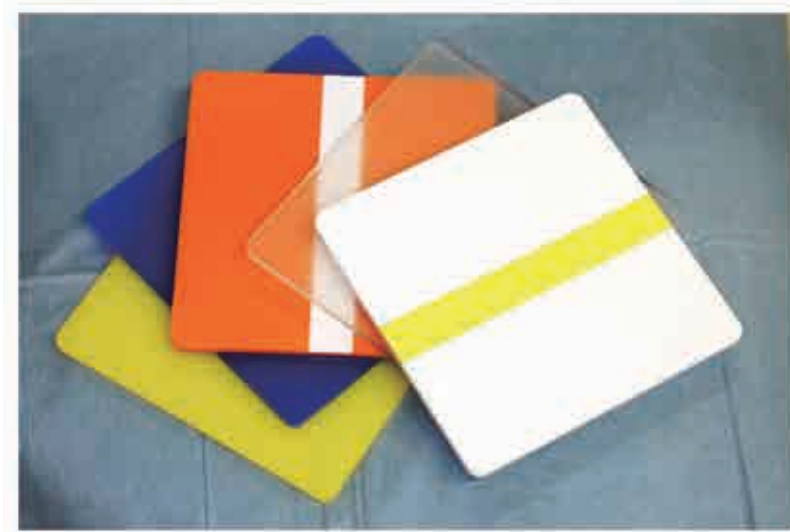
図9 マウスガード用シート材料 マウスガード製作用のシート材は、各社より市販されており、種々の色と厚さを選択することができる。
