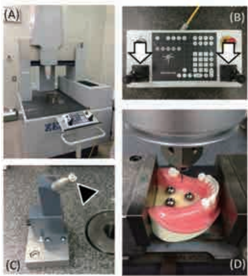
図 2. CNC 三次元座標測定機による基準模型の測定. (A) CNC 三次元座標測定機本体 (B) CNC 三次元座標測定機のコントローラー (矢印) (C) 校正済みの高精度球 (矢印) (D) 基準模型に装着したボールアバットメントのボール中心部の三次元的な位置の測定
