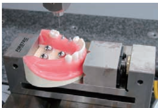
図2. 接触式三次元座標測定機による基準模型の測定 接触式三次元測定機のスタイラスを基準模型のボールアバットメントに接触させ、アバットメントの三次元的な中心座標を決定し、2本のボールアバットメント間の距離を計測した.
