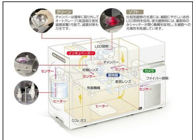
【図 2】培養装置付き蛍光・位相差顕微鏡セット (BioStation IMQ、ニコン) の構成図: 35mm プラスチック培養皿上の培養細胞を、長時間にわたり観察可能である。また、登録した多点ポイントを 100 倍 ~ 400 倍まで観察でき、縦軸 (Z 軸) 方向にもスキャンが可能である。さらに、撮像した写真を動画で再現することにより、ダイナミックな細胞の状態が観察できる。また、分割チャンバーを利用することで、多種類の薬剤や濃度による変化を同時に観察し解析できる利点がある。
